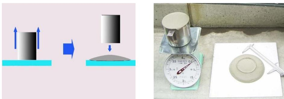
图B.1 湿容重、流动度测定示意图
